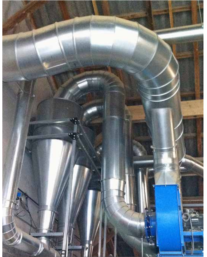
Zyklon 750 mit automatischer Entleerung Cyclon 750 with automatic cleaning
