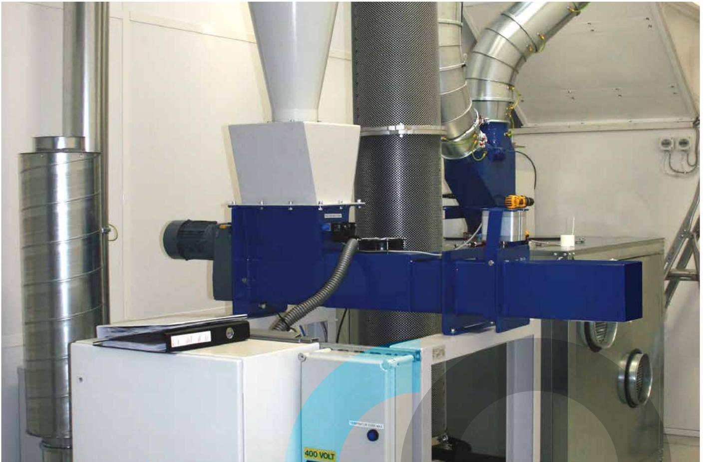
Der Kompaktor ermöglicht das zusätzliche Verdichten von Substraten um bis zu 80 % ihres ursprünglichen Volumens. Das System kann problemlos an bestehenden Anlagen nachgerüstet werden.
