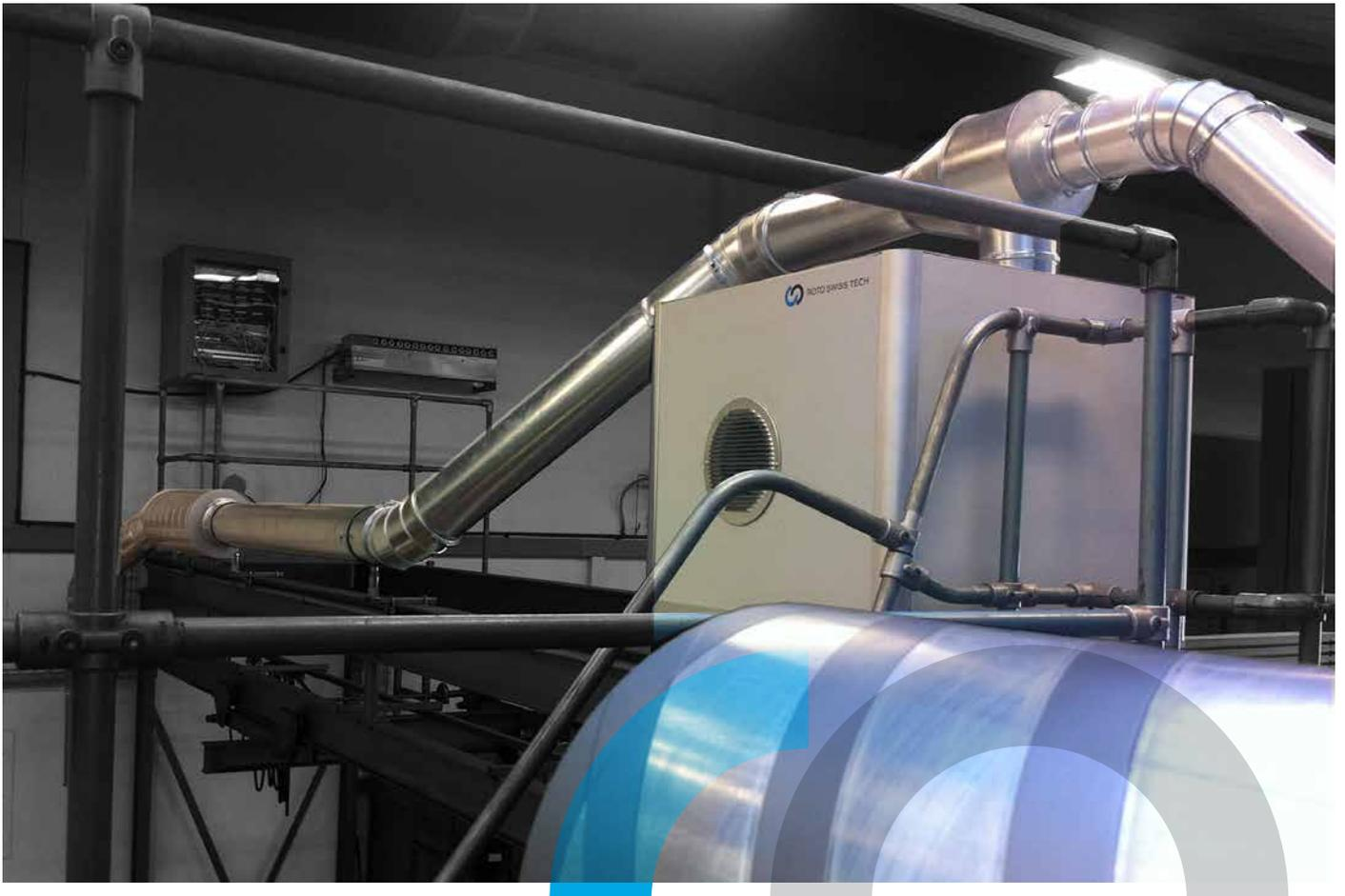
Absauganlage zur Inline Entsorgung von Randstreifen aus Papier, Folie, Textil, Aluminium und ähnlichen Substraten.
