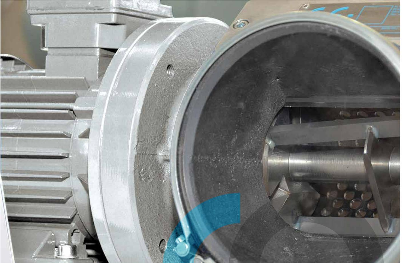
Rohrcutter für den Einsatz zur Zerkleinerung von Randstreifen, Stanzgittern, Folien, Aluminium und ähnlichen Substraten.
